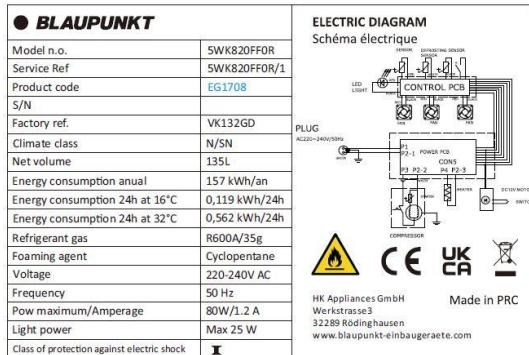
Navnepladen, der sidder på indersiden eller bagsiden af apparatet (afhængigt af modellen), indeholder alle de oplysninger, der er specifikke for dit apparat.
