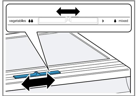
Deslizar el regulador de humedad para ajustar la humedad del aire en el cajón para fruta y verdura en función de la naturaleza y la cantidad de alimentos que se vayan a guardar en el mismo:
